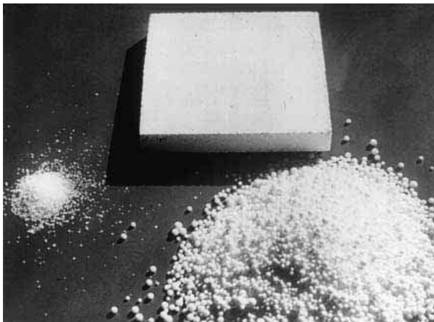
Figura 30 - Os estágios de produção do EPS: pérolas, grânulos expandidos e bloco moldado
