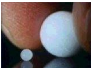
Figura 29 - Pérola de poliestireno antes e depois de sofrer pré-expansão
